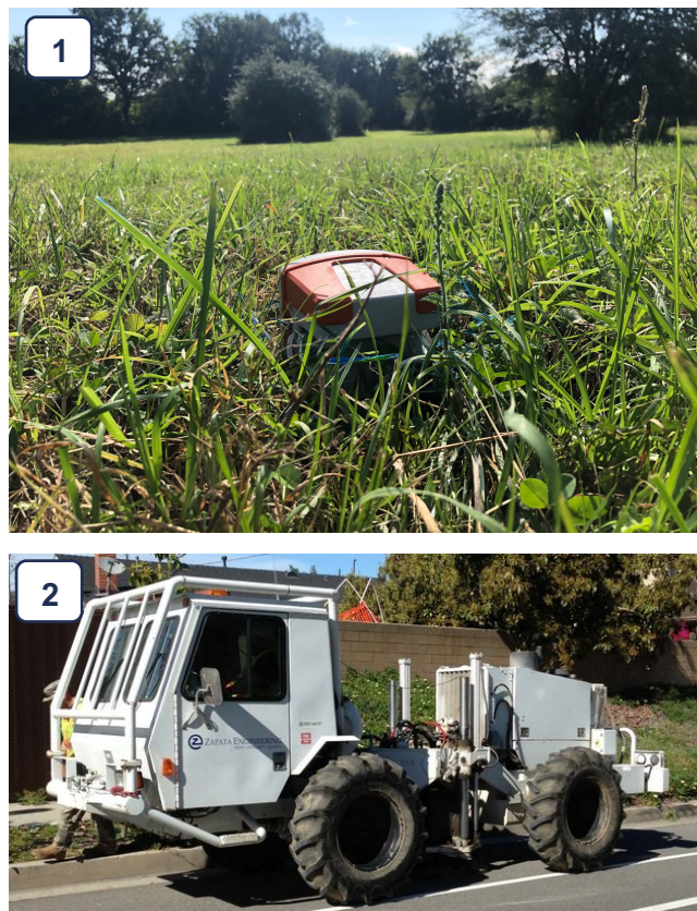
Figure 4 : 1 - Exemple de géophone sans fil planté dans un champs ; 2 - Exemple d'un camion vibreur (Envirovibe)
