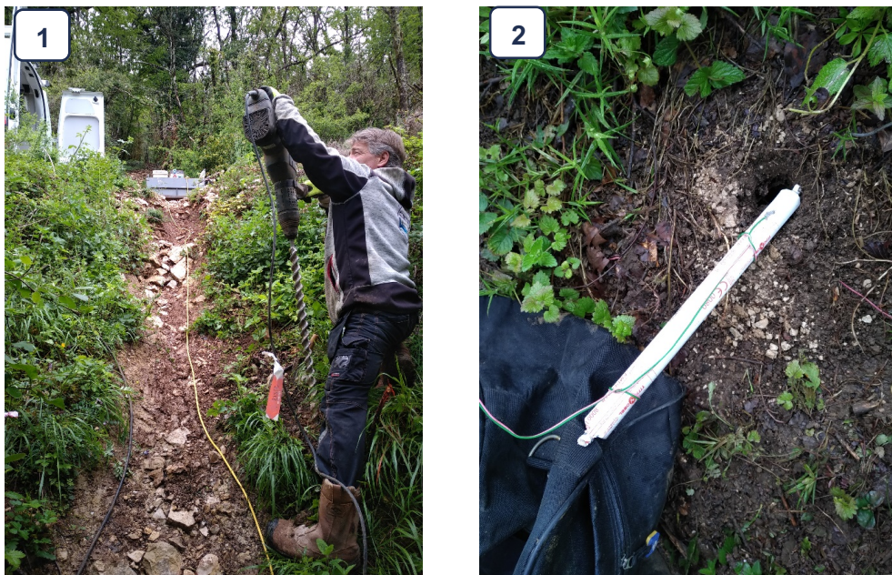
Figure 5 : 1- Exemple de réalisation de petits trous pour la mise en place de charges explosives au perforateur en forêt ; 2 - Exemple de l'installation d'un cylindre explosif dans le trou (Crédits : BRGM)
